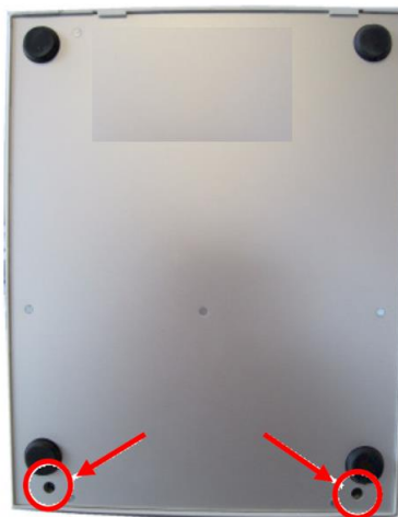
Рисунок 1– Винты в нижней части корпуса пульта
